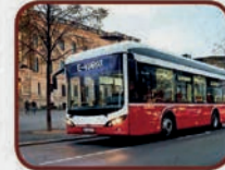
Bozankaya tarafından üretilen elektrikli otobüsler, yaklaşık 300 kilometre menzile sahip ve saatte azami 75 kilometre hıza ulaşabiliyor.
